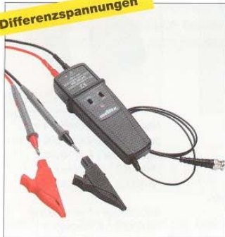
Differenzspannungssonde MX 9030-Z P01.6524.01Z gem. IEC 1010-1, Cat. IV-2 Ermöglicht die Anzeige von hohen Differenzspannungen bis \pm 600 V auf einem Oszilloskop bei voller Sicherheit. Bandbreite: 30 MHz Siehe S. 85
