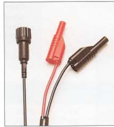
Kabel BNC-Stecker/Bananen- stecker mit axialer Buchse AG1042 (Satz mit 10 Kabeln) AG1066-Z (Satz mit 2 Kabeln) Impedanz: 50 Ω Länge: 1 m gem. IEC 1010-2-031, 500 V, Cat. I
