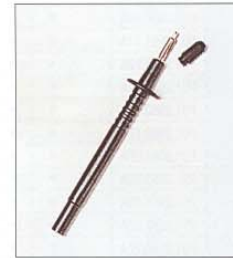
„Freihand“-Prüfspitze P03.1008.28 Mit Sicherheits-Griffschutz, Direktanschluss an Multimeter mit Ø 4 mm-Stecker Länge: 130 mm Max.zul. Spannung: 900 V Lieferumfang: 1 x schwarz
