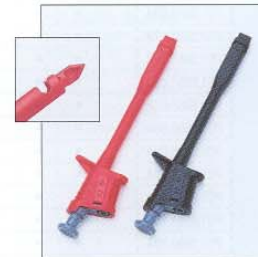
Abgreifer „Einstech-Nadel“ P01.1019.46 Max. zul. Spannung: 30 V AC / 60 V DC Max. zul. Strom: 6 A Für Leitungs-Ø von 1,2 bis 3,5 mm Länge: 150 mm Lieferumfang: 1 x rot, 1 x schwarz
