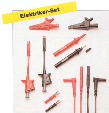
Elektriker-Set Sicherheits-Zubehörsatz für Elektriker P01.1018.93 2 Krokodilklemmen (rot/schwarz), 2 biegsame Abgreifer „Krokodilklemmen“ (rot/schwarz), 2 Prüfspitzen Ø 4 mm (rot/schwarz), 2 Messleitungen 1,5 m mit geradem und Winkelstecker (rot/schwarz), 2 Kabelschuhe Ø 4 mm (rot/schwarz)
