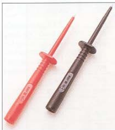
feine Prüfspitzen P01.1018.56 Mit Sicherheits-Griffschutz IEC 61010-2-031, 1000 V, Cat. III Max.zul. Strom: 20 A Länge: 140 mm Lieferumfang: 1 x rot, 1 x schwarz
