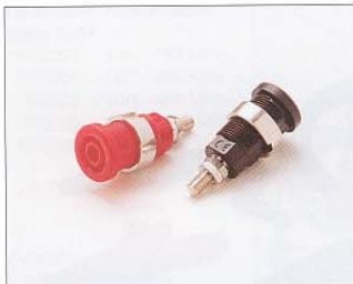
Einbaubuchsen Ø 4 mm mit M4-Mutter * gem. IEC 61010, 1000 V, Cat. III Max.zul. Strom 36 A
