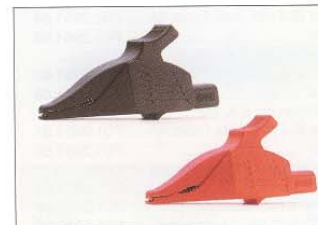
Krokodilklemmen Ø 4 mm P01.1018.49 Mit Sicherheits-Griffschutz, mit Klemmeinrichtung für Kabel gem. IEC 61010, 1000 V, Cat. III Max.zul. Strom 12 A Länge: 158 mm Lieferumfang: 1 x rot, 1 x schwarz, 1 x blau, 1 x weiß, 1 x grün/gelb
