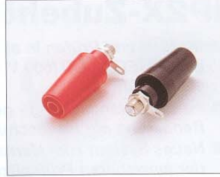
Aufsetzbuchsen Ø 4 mm mit M6-Mutter * gem. IEC 61010, 1000 V, Cat. III Max.zul. Strom 36 A
