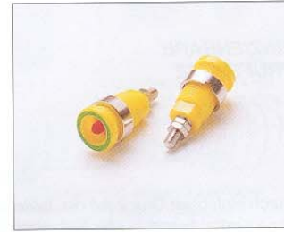
Sicherheits-Stiftkontakte Ø 4 mm * P01.1018.45A Mit Schutzvorrichtung gegen das Einstecken von normalen Stiftkontakten gem. IEC 61010, 1000 V, Cat. III Max.zul. Strom 36 A Schraubmutter: 14,5 mm Zweifarbig grün/gelb
