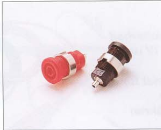
Einlötbuchsen Ø 4 mm * gem. IEC 61010, 1000 V, Cat. III Max.zul. Strom 25 A
