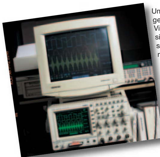
Direkter Anschluss eines VGA-Großbildschirms an das OX 2000
