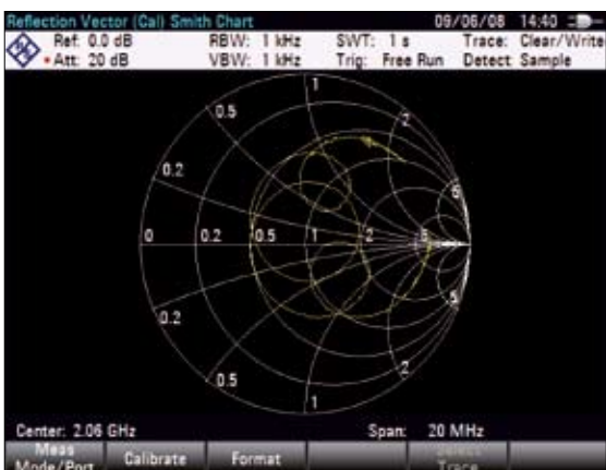
Vektorielle Netzwerkanalyse: Messung mit Smith-Diagramm.
