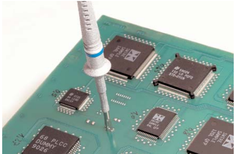
Freihändiges Messen mit dem PCB Adapter
